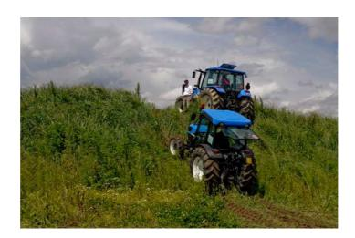
✓ Realizzazione di solchi trasversali e longitudinali: simulano una carreggiata profonda, un piccolo fossato o un tratto di aratura profonda. L'esercizio consiste nell'affrontare l'ostacolo adottando le tecniche di sicurezza adeguate, quali: idonea angolazione di approccio, scelta corretta del rapporto, valutazione degli angoli di attacco, uscita e dosso.
