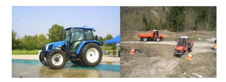
✓ Esecuzione di esercizi di twist in piano, salita e discesa: dovranno essere realizzate buche di dimensione indicativa di 1 m di larghezza x 2 m di lunghezza, di varie profondità. L'esercizio prevede il superamento dell'ostacolo con conseguente perdita di aderenza, adottando le tecniche di sicurezza adeguate nelle tre diverse condizioni.
