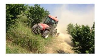
✓ Realizzzaione di salite e discese: Svolgimento di tre esercizi con diverse pendenze e lunghezze del tratto da superare. L'esercizio consiste nell'affrontare l'ostacolo adottando le tecniche di sicurezza adeguate, quali: corretta valutazione del mezzo e dell'attrezzatura portata, semiportata o trainata, marcia e velocità idonea, traiettoria.
