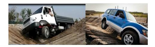
✓ Simulazione di un ostacolo che permetta un cambio di pendenza L'esercizio consiste nell'affrontare l'ostacolo adottando le tecniche di sicurezza adeguate, quali: corretta valutazione del mezzo e dell'attrezzatura portata, semiportata o trainata, marcia e velocità idonea, traiettoria.
